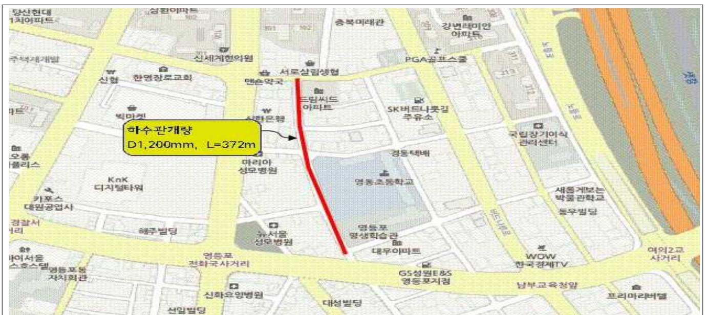
영등포구 선유도역 ~ 롯데제과 주변 일대는 집중호우시 통수능 부족에 따른 노면수 침수로 인한 교통불편이 있고 노후 구배불량으로 침하로 인한 민원이 자주 발생되고 있어 통수능력을 향상시키고자 기존의 하수관거를 개량하여 안전사고 예방과 쾌적하고 편리한 도시환경을 조성코자 함
