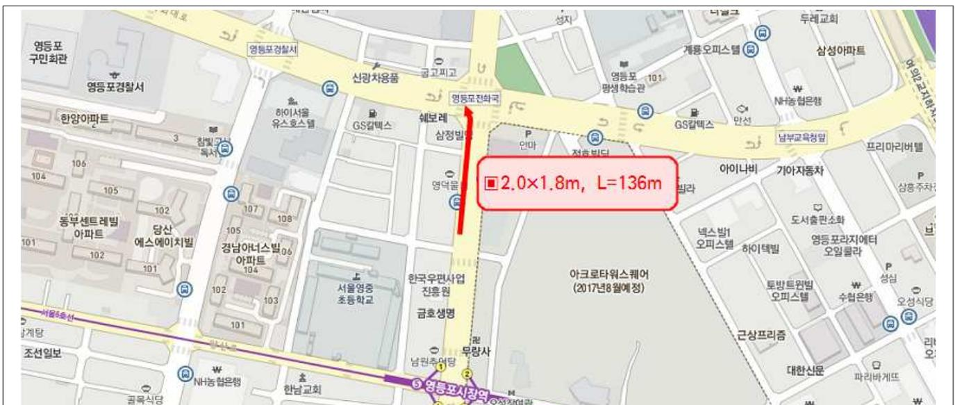
영등포구 영등초등학교 주변 일대는 집중호우시 통수능 부족에 따른 노면수 침수로 인한 교통불편이 있고 노후 구배불량으로 침하로 인한 민원이 자주 발생되고 있어 통수능력을 향상시키고자 기존의 하수관거를 개량하여 안전사고 예방과 쾌적하고 편리한 도시환경을 조성코자 함
